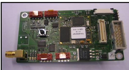
Abbildung 3 Prototyp eines Stand-alone-Horizon-Providers von Navteq (Navteq Map and Positioning Engine).
