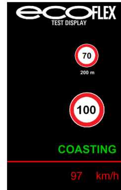
Abbildung 8 Abbildung einer Coasting -Empfehlung, bei der die Geschwindigkeit innerhalb der nächsten 200m von 100km/h auf 70km/h herabgesetzt werden soll. Die aktuelle Geschwindigkeit beträgt 97km/h.
