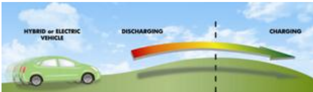
Abbildung 5 Durch frühe Kenntnis des 3D-Straßenprofils kann das Energiemanagement eines Hybrid- oder Elektrofahrzeugs entscheidend verbessert werden.
